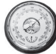
El barómetro es el instrumento que se utiliza para medir la presión atmosférica.
